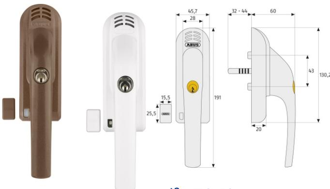
Die Magnetfeldsensorik reagiert sofort auf jeden Hebelversuch und meldet ihn mit einer Lautstärke von 110 dBA. Fehlalarme sind ausgeschlossen. Dient auch der Kindersicherheit. Einsetzbar an Fenstern aus Aluminium, Holz oder Kunststoff.
