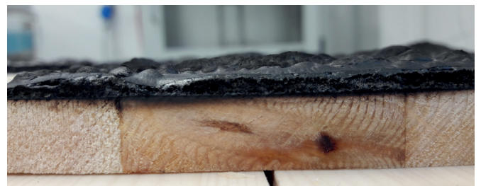
NACH DEM KONTAKT MIT DER FLAMME BILDET SICH AUF DEM SUBSTRAT EINE HOLZKOHLESCHICHT
