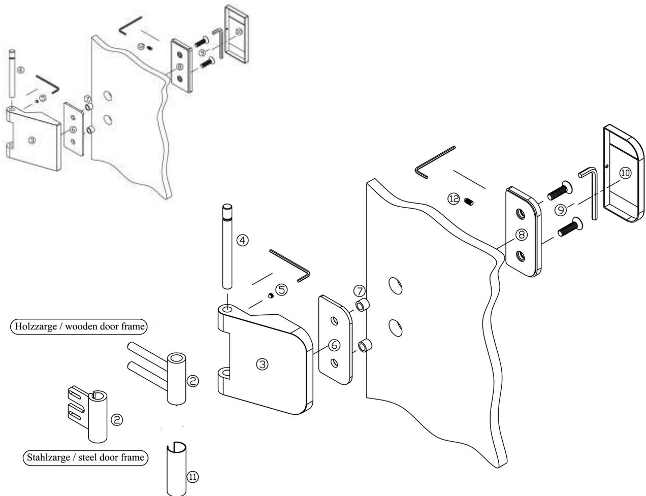
1. Kunststoffringe (7) in die Glasbohrungen stecken, Bandteil (3) + Platte (6) (Halteplatte nur bei Oberfläche Edelstahl matt) mit Gegenplatte (8) durch Senkkopfschrauben (9) befestigen
