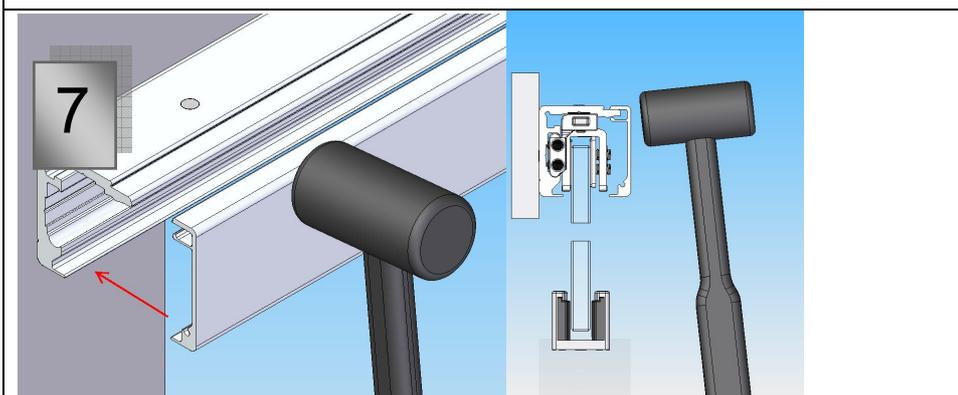
Montieren Sie nun das Abdeckprofil am besten mit Hilfe eines Gummihammers. Prüfen Sie bitte den optimalen Sitz des Deckprofils. Das Deckprofil rastet fest im Grundprofil ein und kann so, ohne größeren Kraftaufwand, nicht mehr gelöst werden.
