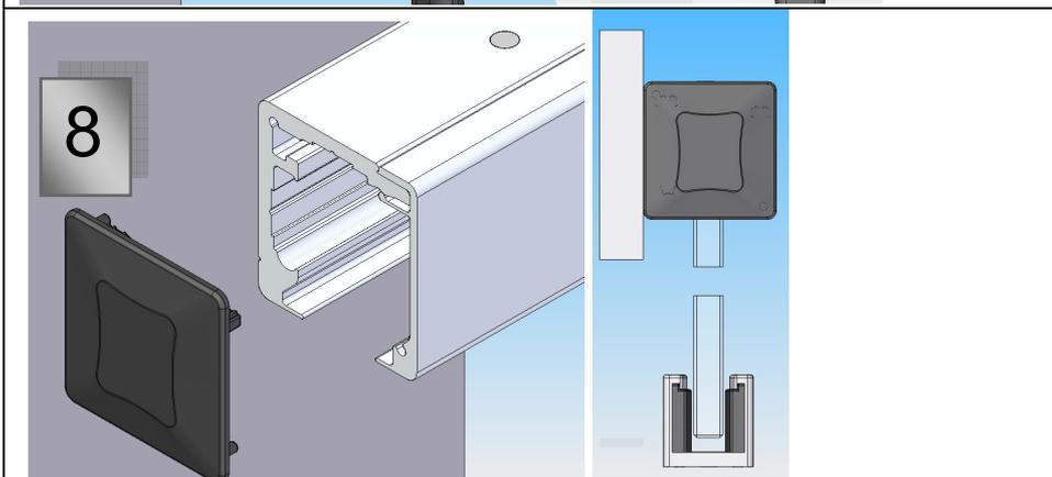
Stecken Sie zum Schluss nun die Endkappen links und rechts auf das Laufprofil auf und prüfen danach nochmals den optimalen Lauf der Schiebetüre.
