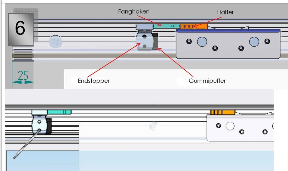
Bevor Sie nun den Stopper festziehen, sollte die Türe mit den Außenkanten 25 mm Abstand zum Laufschienenende aufweisen. Dabei sollte der Fanghaken nicht im Halter eingerastet sein. Montieren Sie den Stopper mittels dem beigefügten Inbusschlüssel auf dieser Position. In geöffneten oder geschlossenen Zustand muss die Glastüre mind. 5 mm Abstand zur Laufschieneaußenkante aufweisen. Sollte dieses Mindestmaß nicht gegeben sein, müssen Sie den Endstopper neu ausrichten.
