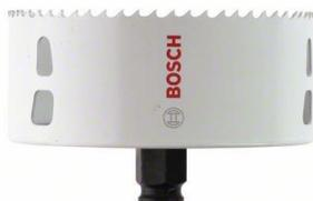
Die BiM Progressor Lochsäge bietet eine 2-fach höhere Lebensdauer als ihr Vorgänger. Für eine bessere Haltbarkeit wurde sie mit Bosch Bi-Metall mit 8% Kobaltlegierung versehen. Darüber hinaus verfügt sie über eine verbesserte progressive Zahnleiste, die schnellere Schnitte ermöglicht. Diese Lochsäge für das Bohren von Löchern in Holz, Trockenbauwände, Kunststoffe, Metalle, Nichteisenmetalle und Edelstahl verwenden. Es ist für alle Akku- und Netzbohrschrauber geeignet.
