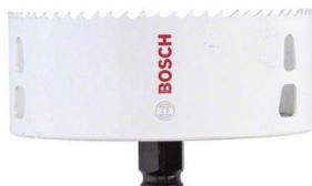
Die BiM Progressor Lochsäge bietet eine 2-fach höhere Lebensdauer als ihr Vorgänger. Für eine bessere Haltbarkeit wurde sie mit Bosch Bi-Metall mit 8% Kobaltlegierung versehen. Darüber hinaus verfügt sie über eine verbesserte progressive Zahnleiste, die schnellere Schnitte ermöglicht. Diese Lochsäge für das Bohren von Löchern in Holz, Trockenbauwände, Kunststoffe, Metalle, Nichteisenmetalle und Edelstahl verwenden. Es ist für alle Akku- und Netzbohrschrauber geeignet.
