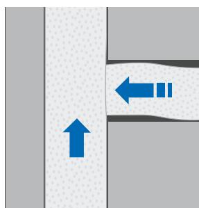
Auch bei der Fenstermontage sollte beim Zuschneiden des Bandes die Zugabe von mindestens 1 cm je Meter Fugenlänge beachtet werden.
