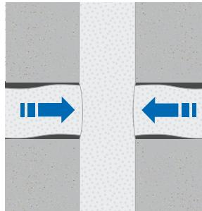
Bei Kreuz- und T-Fügen empfehlen wir, die Bänder der waagerechten Fuge gegen die Bänder der senkrechten Fuge stumpf zu stoßen. Achten Sie darauf, die Bänder zu stauchen.
