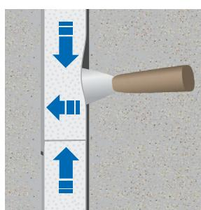
Beginnen Sie bei senkrechten Fugen am unteren Ende und arbeiten dann nach oben weiter. Drücken Sie die selbstklebende Seite (ggf. mit einem Spachtel) fest gegen die Fugenflanke. Bei den Stoßstellen einzelner Bänder müssen diese stumpf gegeneinander gestoßen / gestaucht werden, ohne das Band dabei in die Länge zu ziehen.
